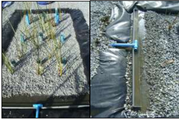
Figura 12: Obstrucción a la entrada de la celda (Clogging).
