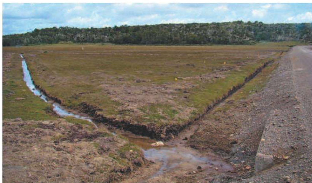
Figura 12. Drenajes en Tierra del Fuego con efecto perjudicial para una turbera. Un drenaje paralelo a la ruta Y-85 confluye con el de un predio privado.
