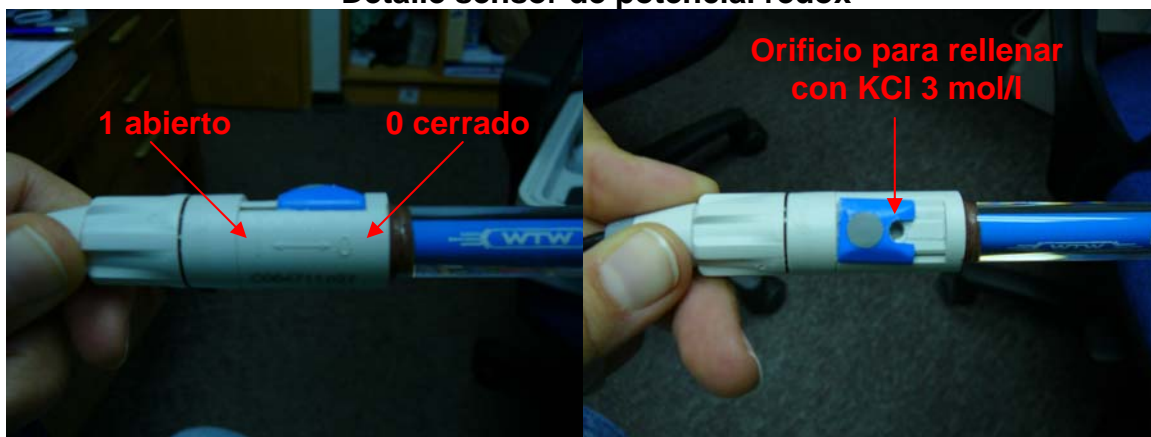
Figura 35 Detalle sensor de potencial redox
