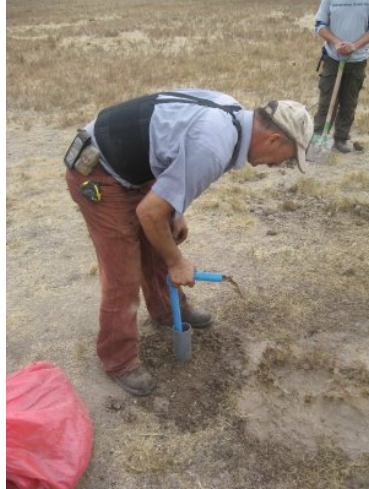
Figura 27 Bombeo manual desde piezómetro
