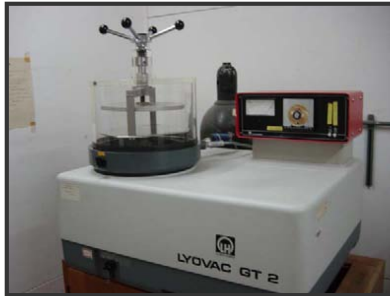
Imagen 5. Equipo Leybold-Heraeus modelo LYOVAC GT2, utilizado en la liofilización de las diferentes porciones de la totora ( Scirpus californicus ).
