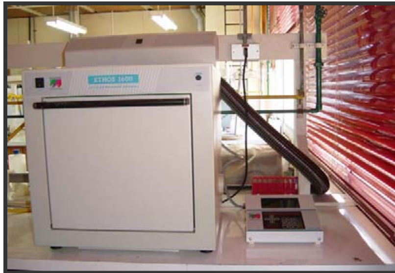
Imagen 2. Horno Microondas Milestone , modelo Ethos 1600, utilizado para realizar digestión ácida de las diferentes porciones de la totora ( Scirpus californicus ).
